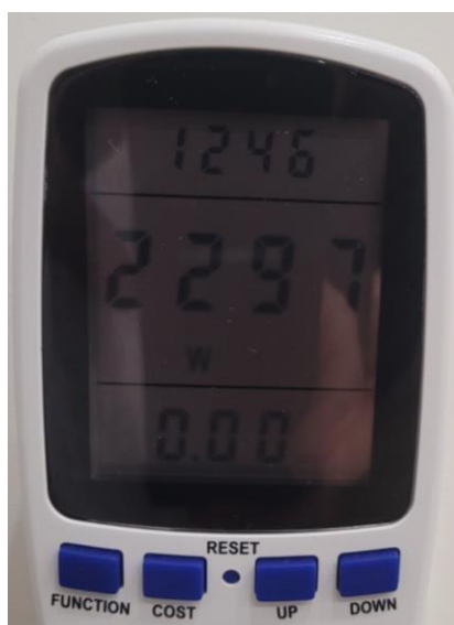
Рисунок 3.5 – Покази вимірювань за допомогою цифрового вимірювача потужності.
