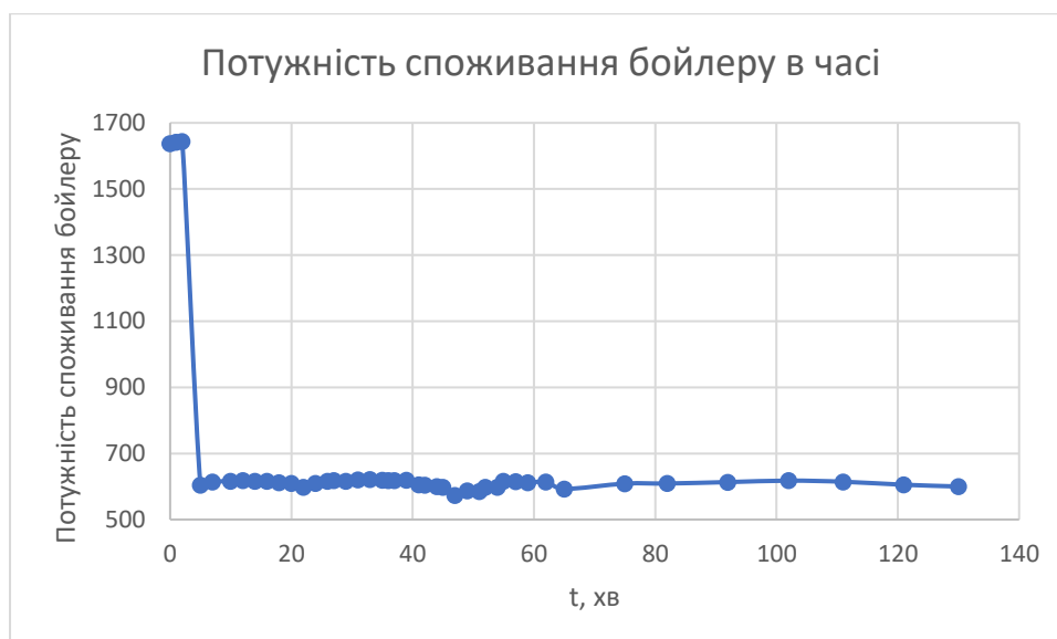
Рисунок 3.3 - Зміна потужності споживання бойлера в часі
