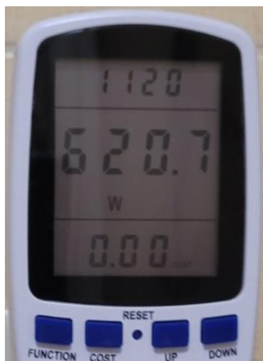
Рисунок 3.1 – Покази вимірювань за допомогою цифрового вимірювача потужності.
