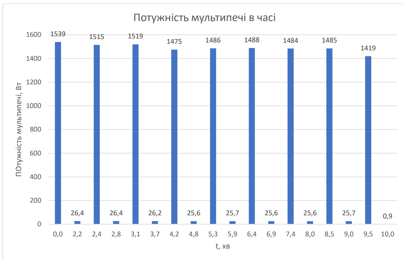
Рисунок 3.11 - Процес роботи мультипечі протягом 10 хвилин
