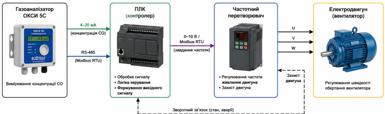
Рисунок 2.3 – Структурна схема підключення газоаналізатора до системи автоматичного керування вентиляцією
