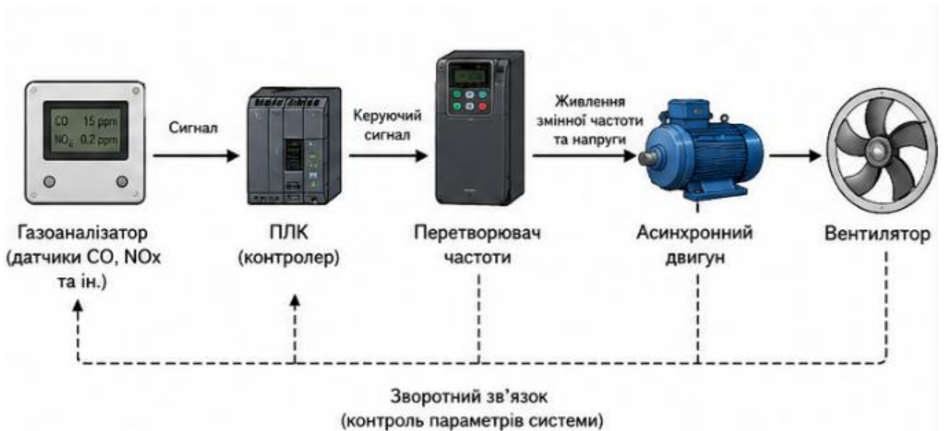
Рисунок 1.4 –Схема структурна системи вентиляції з ЧР електроприводом
