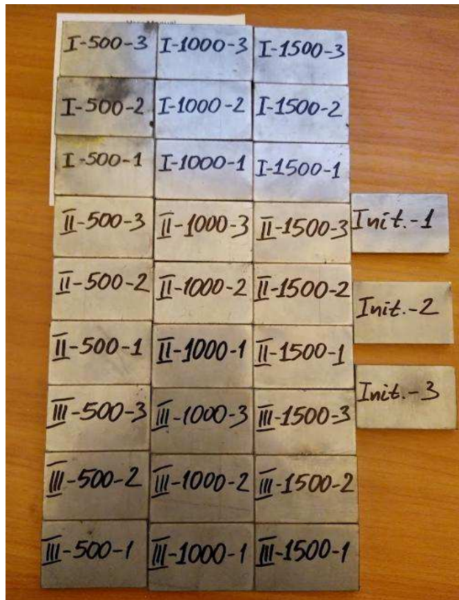
Рисунок 3.2. Маркування експериментальних зразків із вказанням подачі інструменту
