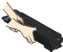
Рисунок 2.9 – Вилучення захисного кожуха
