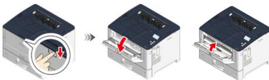
Рисунок 2.26 – Відкриття кришки відсіку завантаження носіїв МРТ
