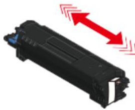
Рисунок 2.7 – Струшування нового картриджа
