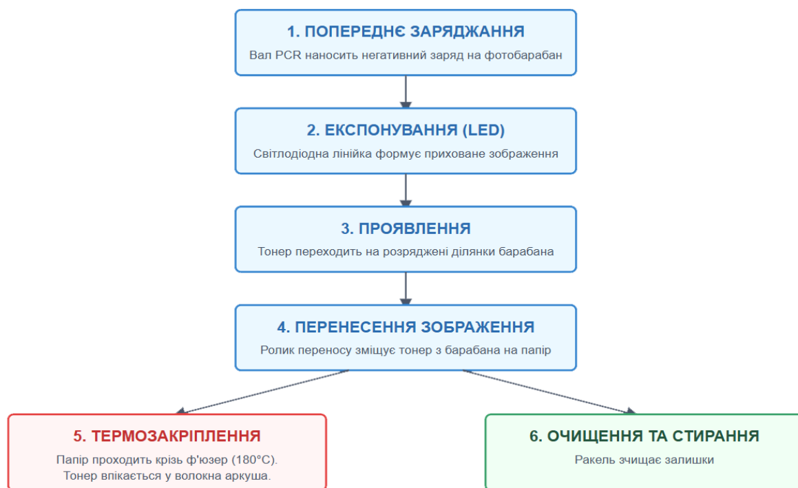
Рисунок 1.1 – Структурна схема етапів друку принтера OKI B432dn
