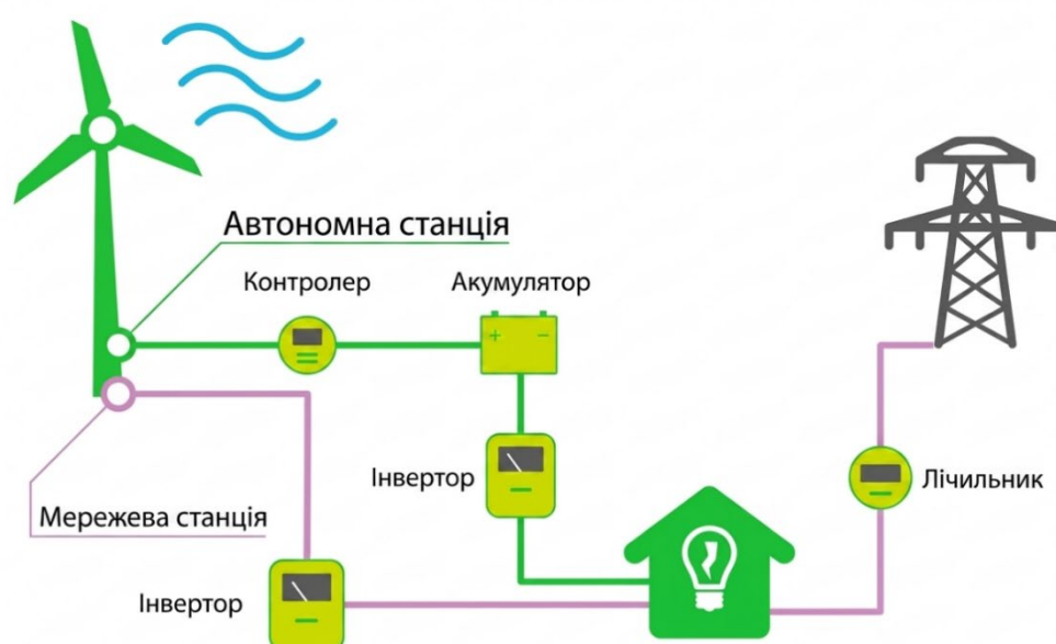
Рисунок 3.4 – Принцип дії вітрогенератора в приватному будинку
