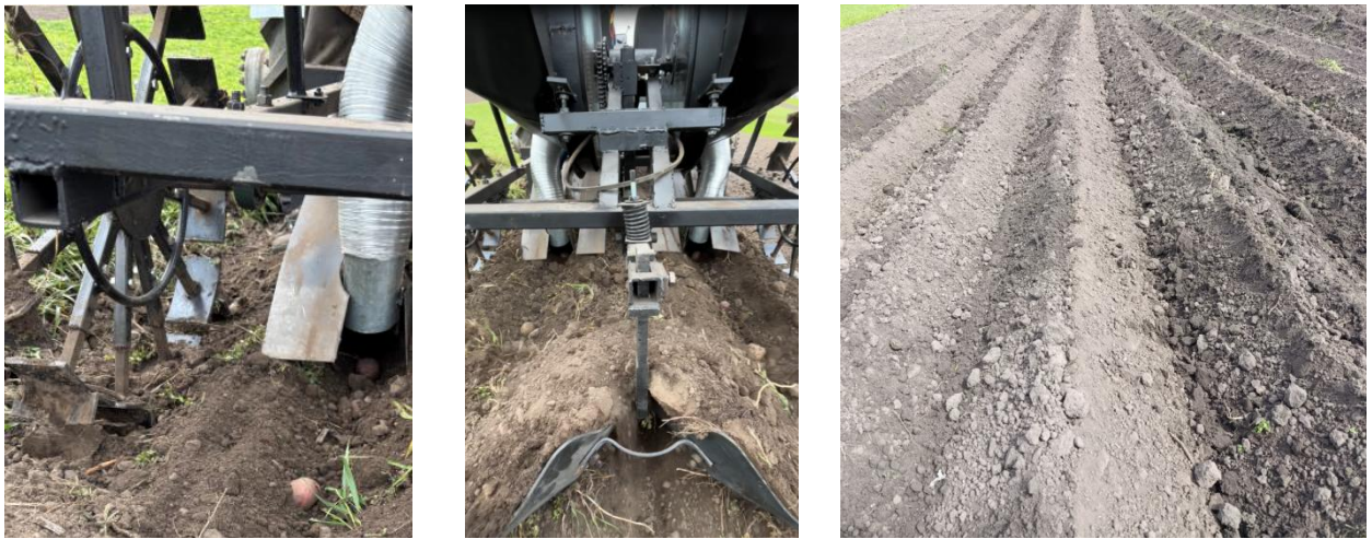
а) – дослідження роботи садильного апарату у «відкритій борозні»; б – робочий режим посадки; в – результат посадки площі Рисунок 4.5 – Польові дослідження роботи вичерпуючого апарату
