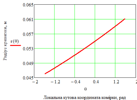
Рисунок 5.9 – Зміна радіуса кривизни комірки вичерпуючого барабана
