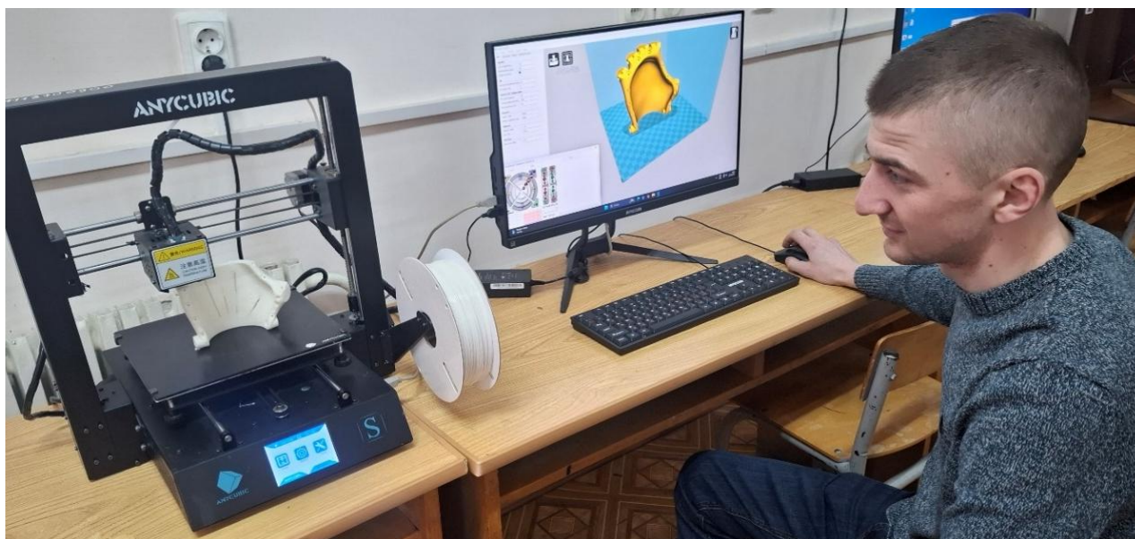
Рис. 2.8. Процес виготовлення елемента долоні протеза
