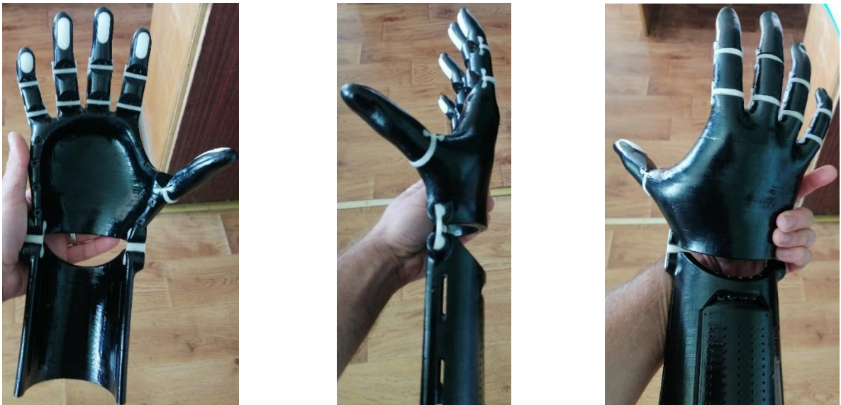
Рис. 2.4. Вигляд виготовленого методом 3D друку протеза Kinetic Hand із рекомендованими розробниками параметрами
