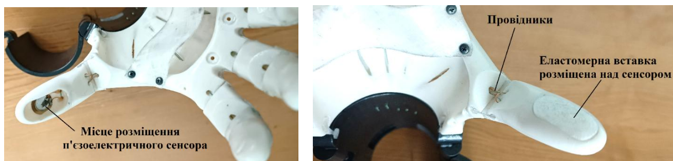
Рис. 2.17. Спосіб розміщення п'єзоелектричного сенсора в дистальній фаланзі великого пальця протеза під еластомерною вставкою
