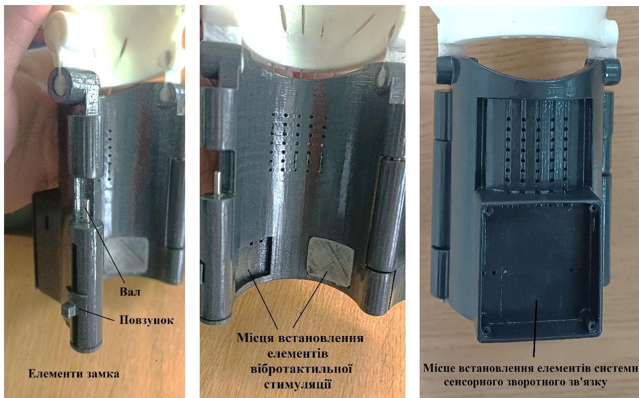
Рис. 2.11. Вигляд деяких елементів удосконаленої конструкції протеза
