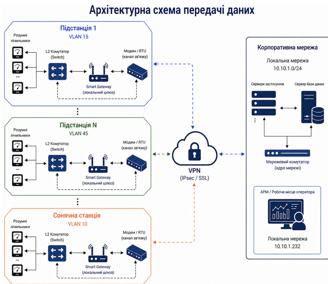
Рисунок 4.2 – Запропонована схема передавання даних електроспоживання
