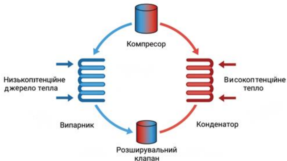
Рисунок 1.1 — Принцип роботи теплового насоса
