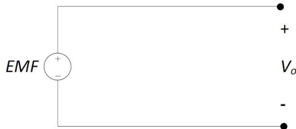
Рисунок 1.1 - Ідеальна еквівалентна схема батареї
