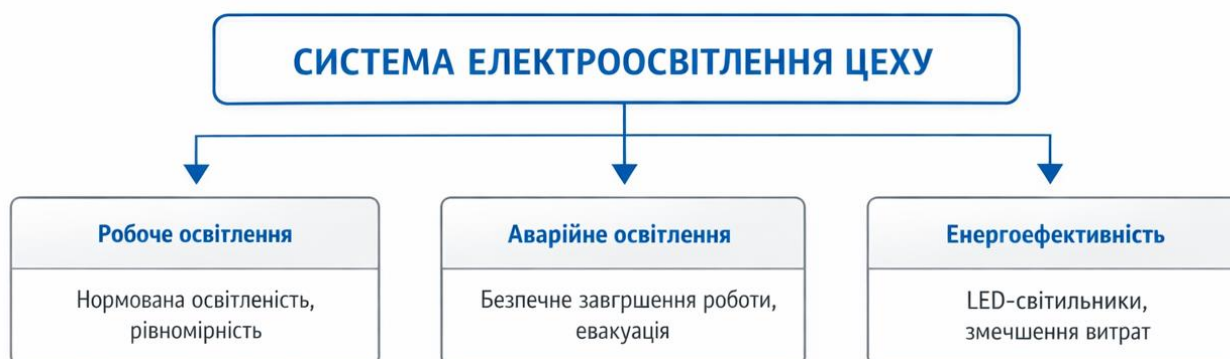
Рисунок 1.2 – Структурна схема основних вимог до системи електроосвітлення робочого цеху
