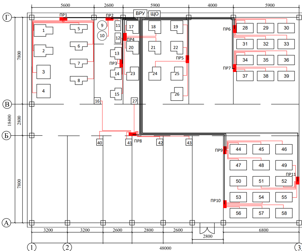
Рисунок 2.5 – Схема електропостачання 2-го рівня з прикладу приміщення робочого цеху
