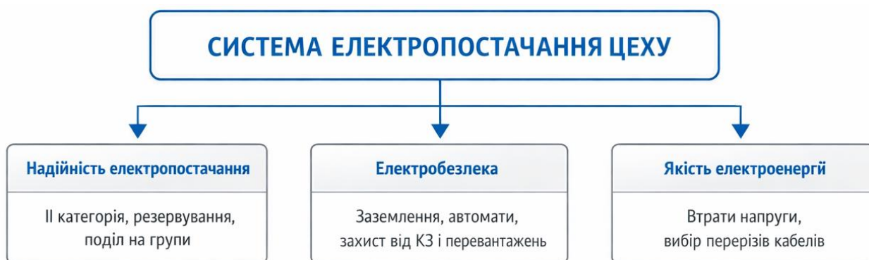
Рисунок 1.1 – Структурна схема основних вимог до системи електропостачання робочого цеху
