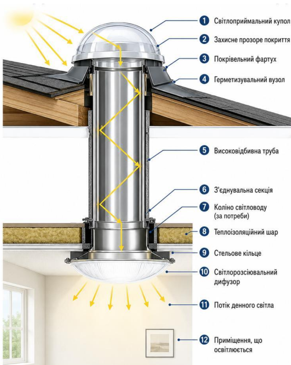
Рисунок 1.7 – Будова сонячного світловоду
