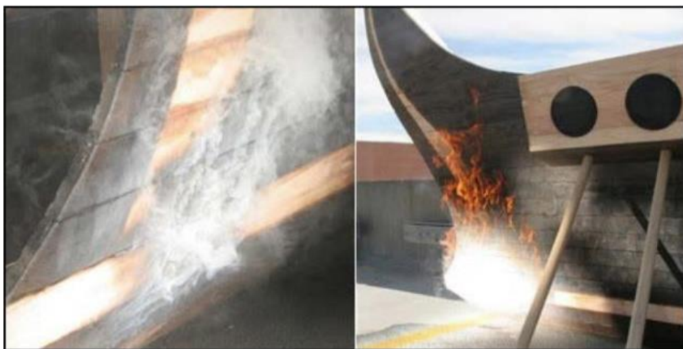
Рисунок 1.7 – Застосування сонячного концентратора для підпалювання деревини
