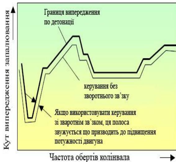
Рис.3. Підвищення потужності двигуна з керуванням по сигналі детонації
