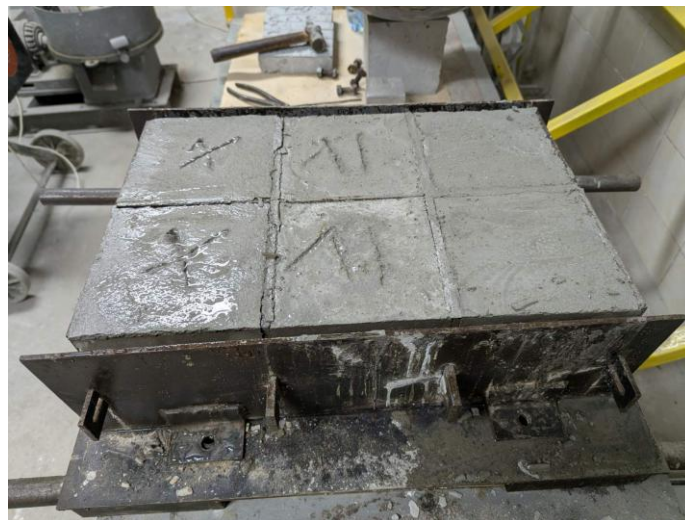
Рис.1 Розпалублення затверділих кубиків
