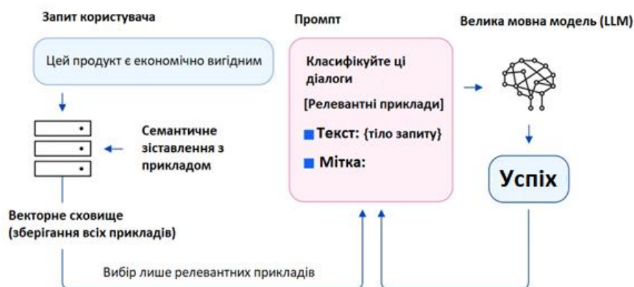
Рисунок 2.7 – Схема динамічного підбору релевантних варіантів через векторне сховище для формування контексту LLM [36]
