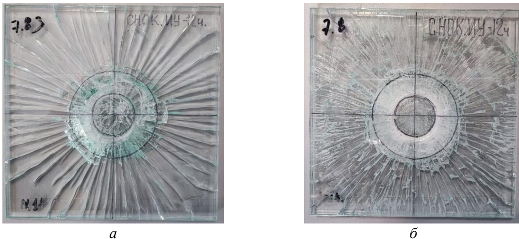
Рисунок 1 – Фотографії зруйнованих пластин флоат-скла з іонно-обмінним зміцненням протягом t = 12 годин: a – зразок № 11, \sigma = 206 МПа; b – зразок № 4, \sigma = 601 МПа.
