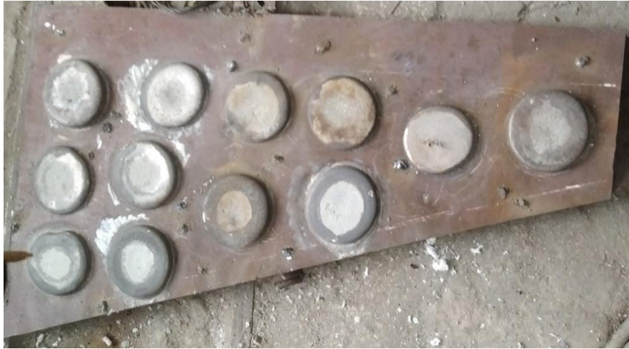
Рисунок 1. Наплавлена «шайбами» футеровка Вільна зона
