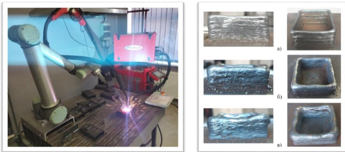
Рисунок 1 – Процес адитивного наплавлення та експериментальні зразки, отримані в процесі CMT (а), Impulse (б) та Standard (в) наплавлення
