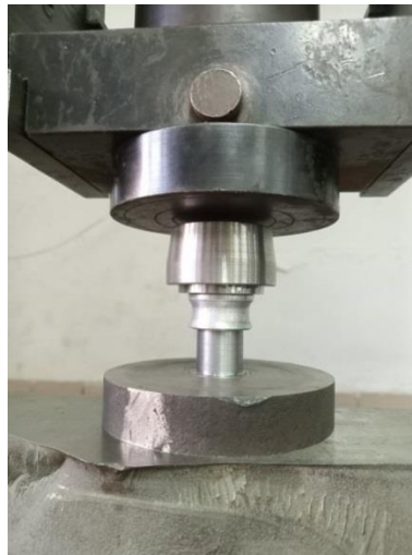
Рисунок 2 – Проведення випробувань сумарної міцності з'єднання сталевій втулці з кільцем з алюмінієвого сплаву
