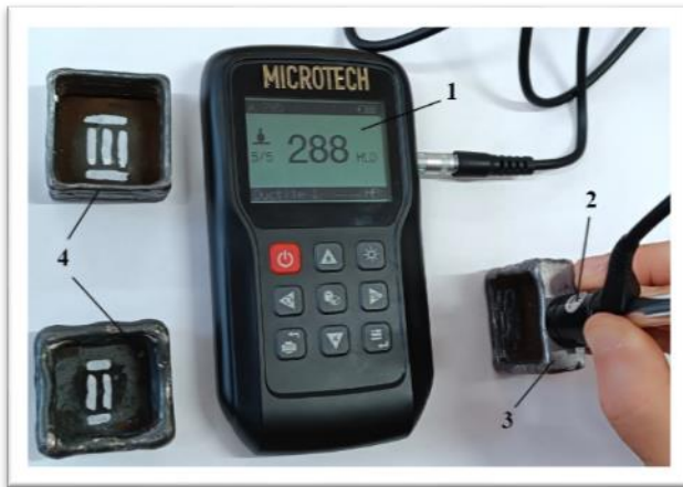
Рисунок 2 – Дослідження твердості матеріалу за допомогою твердоміра ТПУ-1 1 - блок індикації; 2 – індентор; 3 – досліджуваний експериментальний зразок; 4 – експериментальні зразки
