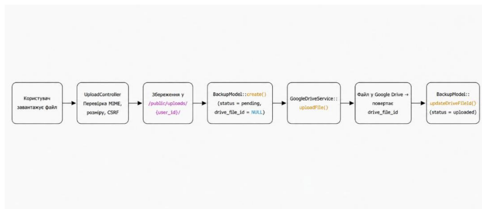
Рисунок 2.4 – Схема роботи з файлами (Upload to Drive to DB)
