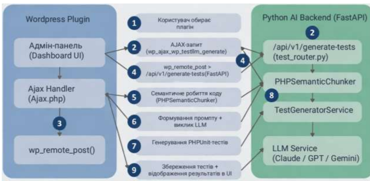
Рисунок 3.9 – Схема взаємодії PHP-плагіна та Python AI Backend
