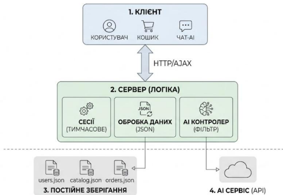
Рисунок 2.2 – Схема організації даних та інформаційних потоків у системі
