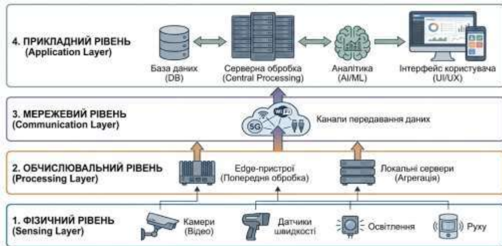
Рис. 1 – Архітектура кіберфізичної системи автоматичної фіксації порушень правил дорожнього руху
