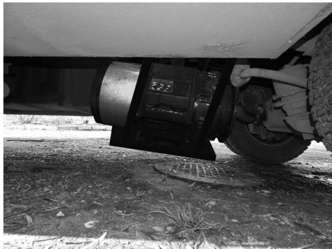
Рисунок 3. Розміщення електродвигуна в задній частині автомобіля
