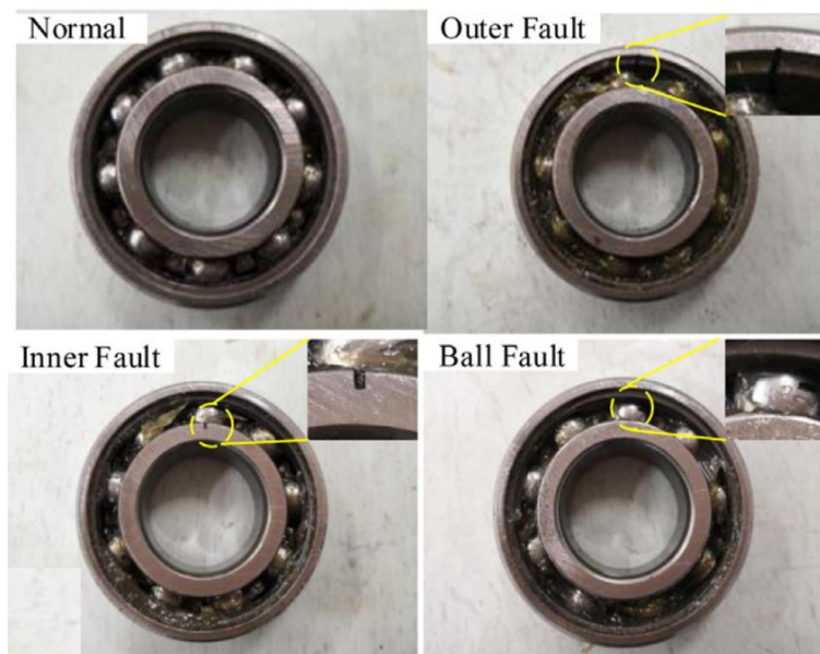
Рисунок 1. Типові дефекти підшипника: нормальний стан, дефект зовнішнього кільця (Outer Fault), дефект внутрішнього кільця (Inner Fault) та дефект тіла кочення (Ball Fault) [4].
