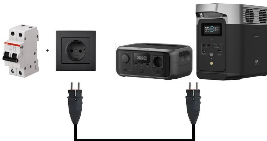
Рисунок 1. Підключення зарядної станції (EcoFlow River 3 та EcoFlow Delta 2) до електричної мережі через кабель типу «вилка-вилка» з можливістю відключення вхідного автоматичного вимикача
