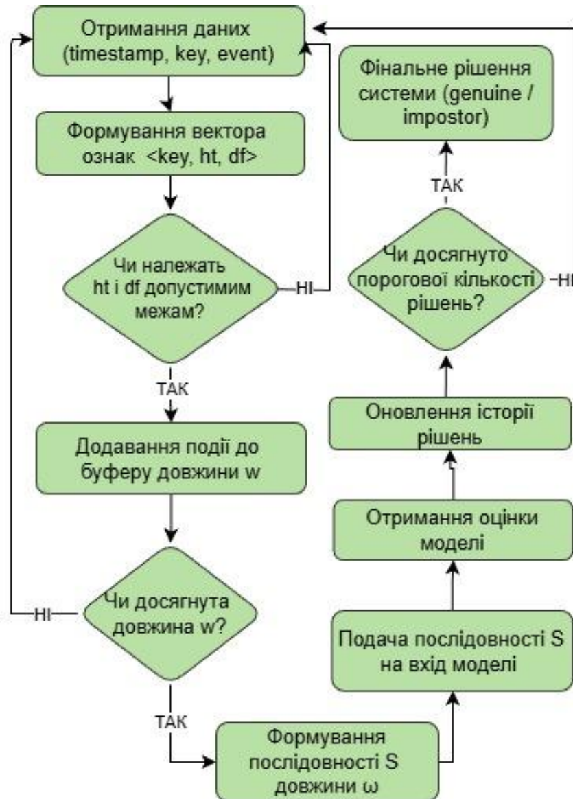
Рисунок 2.5 – Блок-схема алгоритму безперервної автентифікації користувача за клавіатурною динамікою [27]
