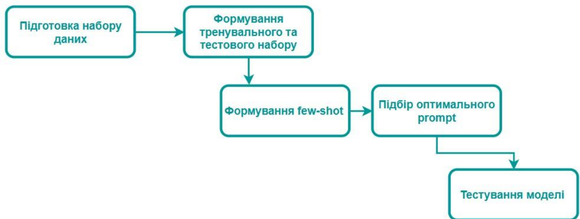
Рисунок 3.2 – Схематичне представлення алгоритму застосування LLM
