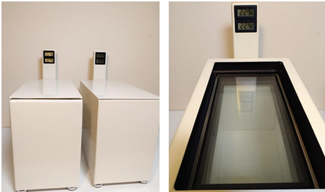
Рисунок 1. Експериментальна установка для визначення коефіцієнта теплопровідності (метод плоскої пластини)
