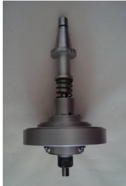
Рисунок 1. Пристрій для розточування ущільнюючих циліндричних поясків під гільзи блоків циліндрів
