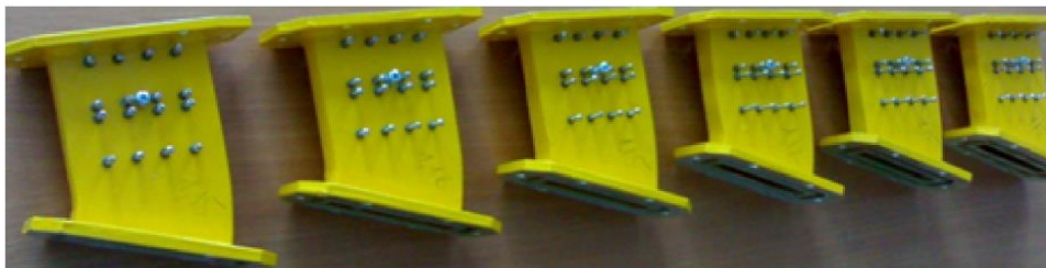
Рисунок 4. Натурні взірці гібридних смуго-пропускних фільтрів НВЧ.
