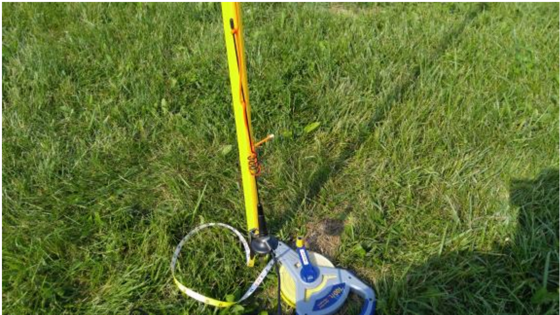
Рис. 3.18 Малогабаритна монопольна антена, застосована для вимірювання діаграми спрямованості петльової антени
