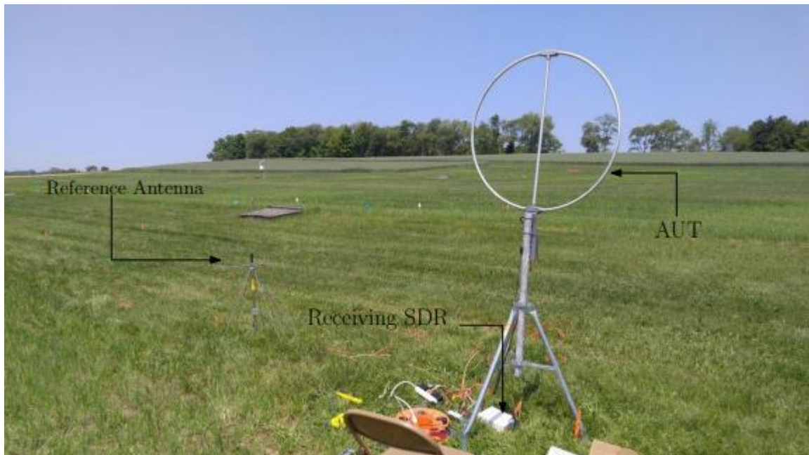
Рис. 3.12 Петльова антена, еталонна антена та приймальний програмно-керований радіоприймач (SDR), встановлені для проведення вимірювань
