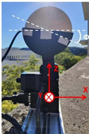
Рис. 1.6. – Кут нахилу PTU та кут внутрішнього обертання LiDAR
