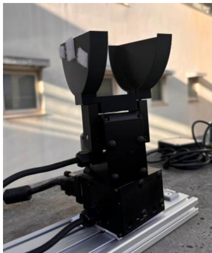
Рис. 2.3. – 3D-друкована опора LiDAR
