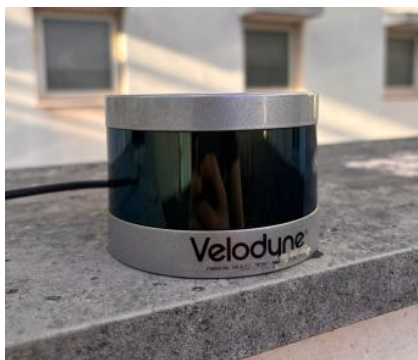
Рис. 2.4. – LiDAR-сенсор Velodyne VLP-16
