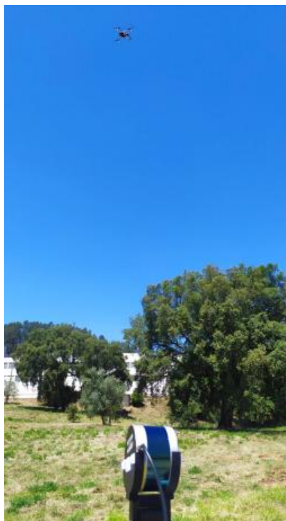
Рис. 2.6. – Система відстеження під час натурних випробувань із зафіксованим БПЛА у полі зору LiDAR
