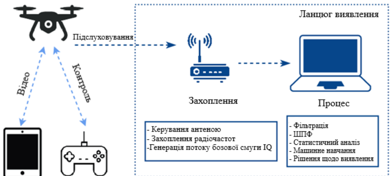
Рис. 1.8. Структурна схема пасивного радіочастотного зондування (РЧ-зондування) для виявлення дронів.
