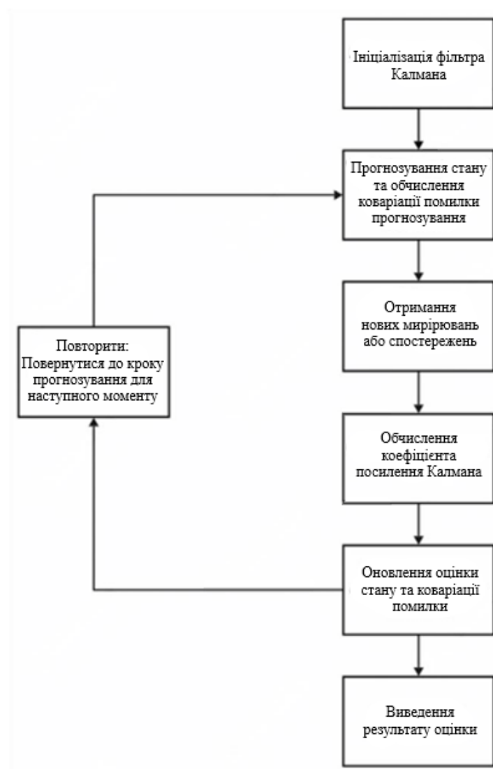
Рис. 2.2. - Конкретні кроки алгоритму фільтра Калмана
