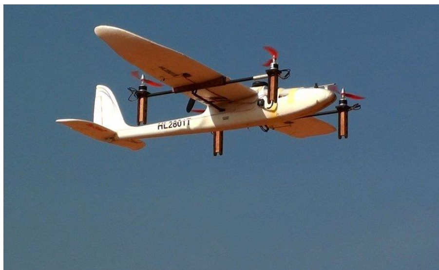
Рис. 1.2. Гібридний БПЛА з фіксованим крилом
