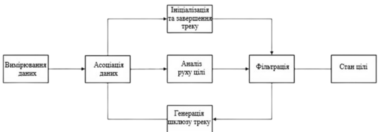
Рис. 2.1. Схематична діаграма застосування фільтра Калмана
