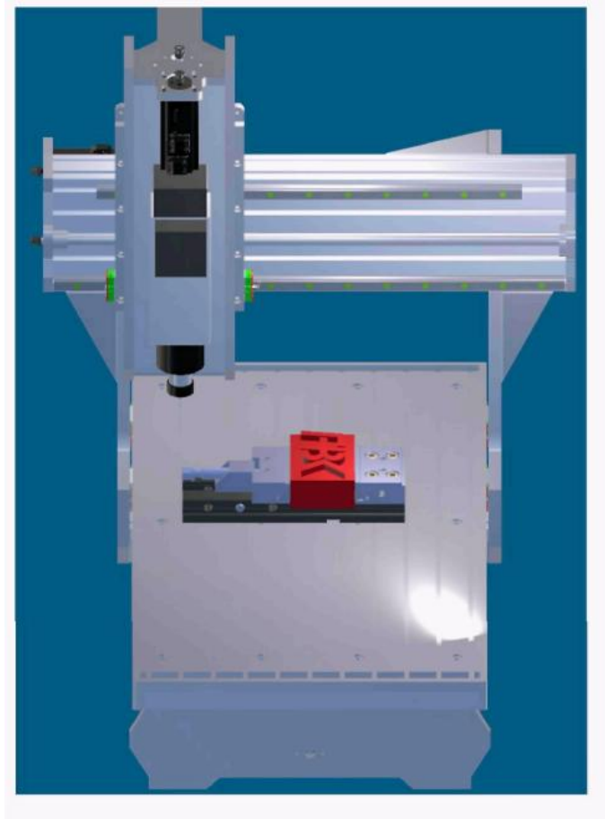
Рис. 1.6. Віртуальне моделювання роботи 3-осьового верстата з ЧПК, що використовується як цифровий двійник.
