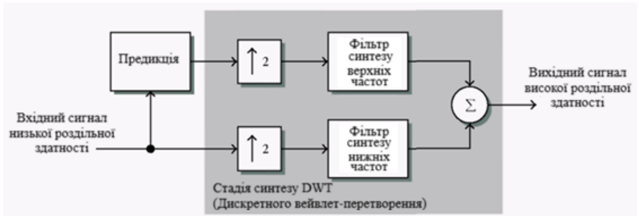
Рис. 2.8: Інтерполяція 1D сигналу на основі вейвлетів. Інтерполяцію 2D зображень можна виконати за допомогою аналогічної системи, що застосовується до піддіапазонів стадії синтезу 2D DWT, або шляхом застосування цієї 1D системи роздільним чином до рядків і стовпців зображення незалежно.
