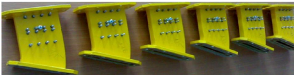
Рисунок 4. Натурні взірці гібридних смугово-пропускних фільтрів НВЧ.
