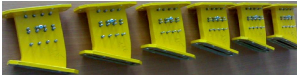
Рисунок 4. Натурні взірці гібридних смугово-пропускних фільтрів НВЧ.
