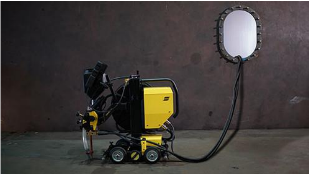
Рисунок 2.2 – Зображення роботи в трактора по зварюванню поздовжніх внутрішніх швів
