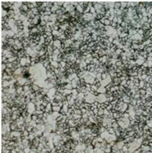
Рисунок 1.3 – Вихідна мікроструктура сталі P235GH, [9]
