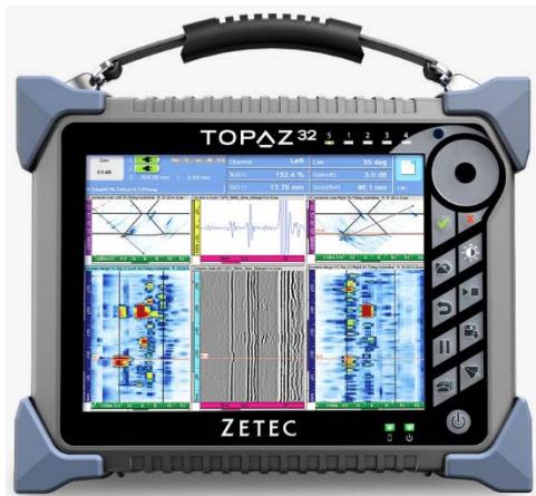
Рисунок 2.9 - Портативний високопродуктивний дефектоскоп TOPAZ32 із фазованою антенною решіткою, [28]
