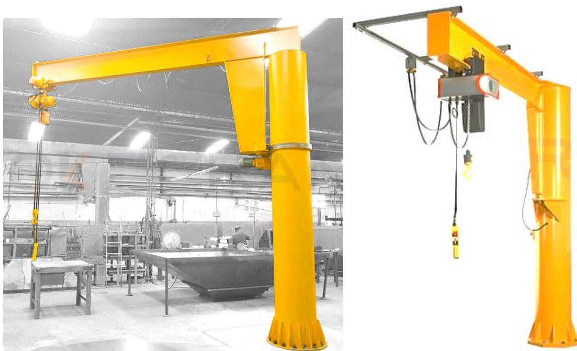
Рис.1.1. Конструкція консольного підлогового крана [4]
