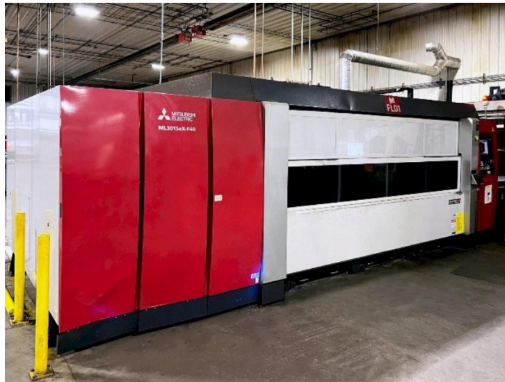
Рис. 3.5 – Лазерна установка для різання листового металу Mitsubishi ML3015eX-S [25]
