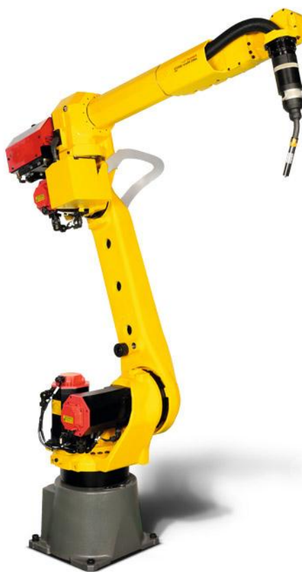
Рис. 3.2 – Промисловий зварювальний робот ARCMate120iC/12L, призначений для роботизованих процесів дугового зварювання [22]
