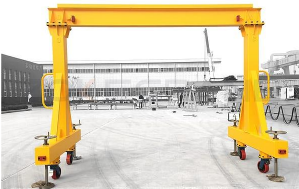
Рис.1.1. Конструкція пересувного козлового крана [4]
