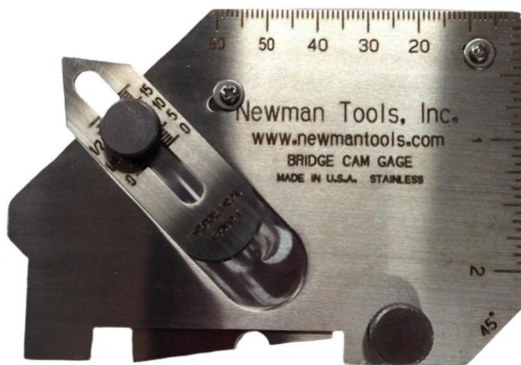
Рис. 3.9 – Шаблон для контролю зварних швів УШС-4 [26]
