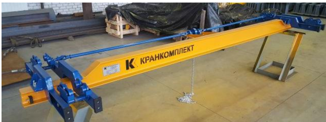
Рис. 1.2 Загальний вигляд підвісної кран-балки малої тоннажності[5]
