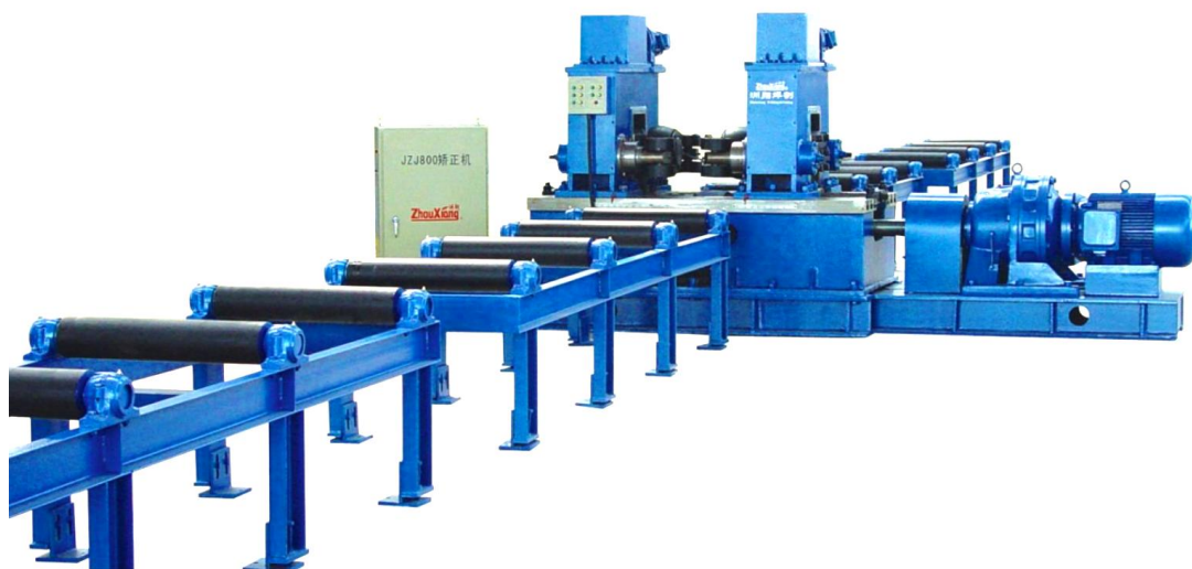
Рис. 3.11 – Правильна машина для усунення деформацій таврових зварних металоконструкцій [25]
