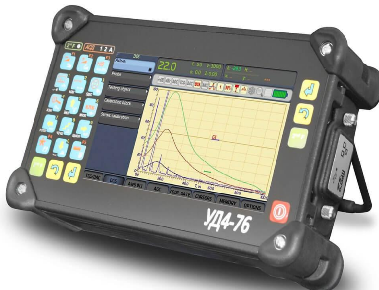
Рис. 3.13 - Ультразвуковий дефектоскоп УД4-76, застосований для контролю зварних з'єднань [28]
