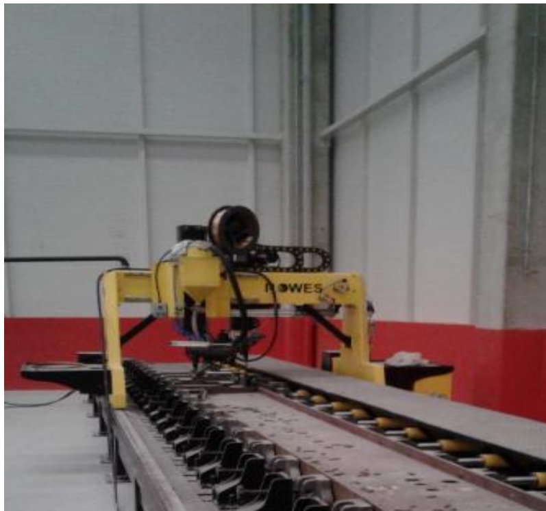
Рис. 4.4 – Кондуктор для зварювання двотаврових балок
