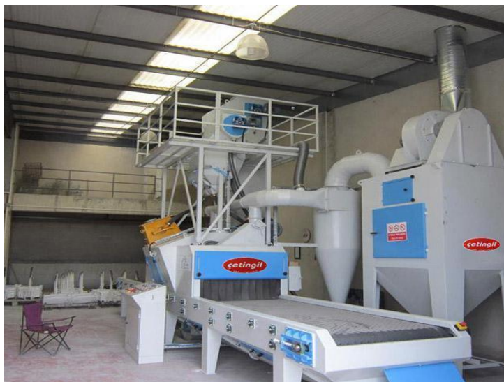
Рис. 3.7 – Дробоструминна установка SK-2 ÇETİNGİL для очищення поверхні листового металу [24]
