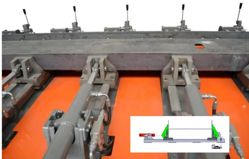
Рис. 3.10 –Складальна стенд-установка для складання підвісної кран-балки
