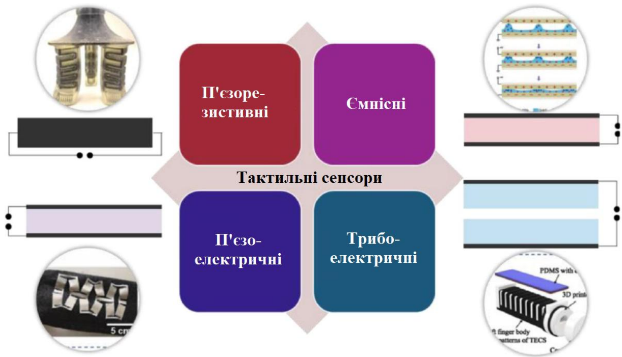
Рис. 2.1. Схематичне зображення чотирьох типів тактильних датчиків, їх типові структури та приклади виконання [27]
