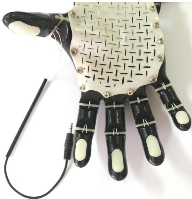
Рис. 3.5. Конструкція протеза із розміщеним одним сенсором у вставці великого пальця
