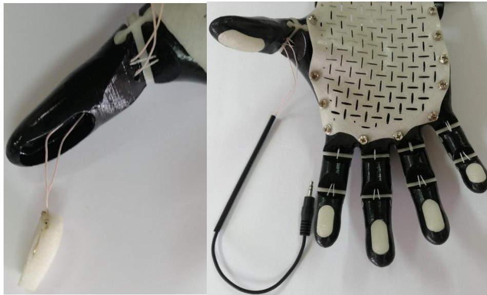
Рис. 2.2. Елементи протеза із розміщеним в еластомерній вставці п'єзоелектричним сенсором
