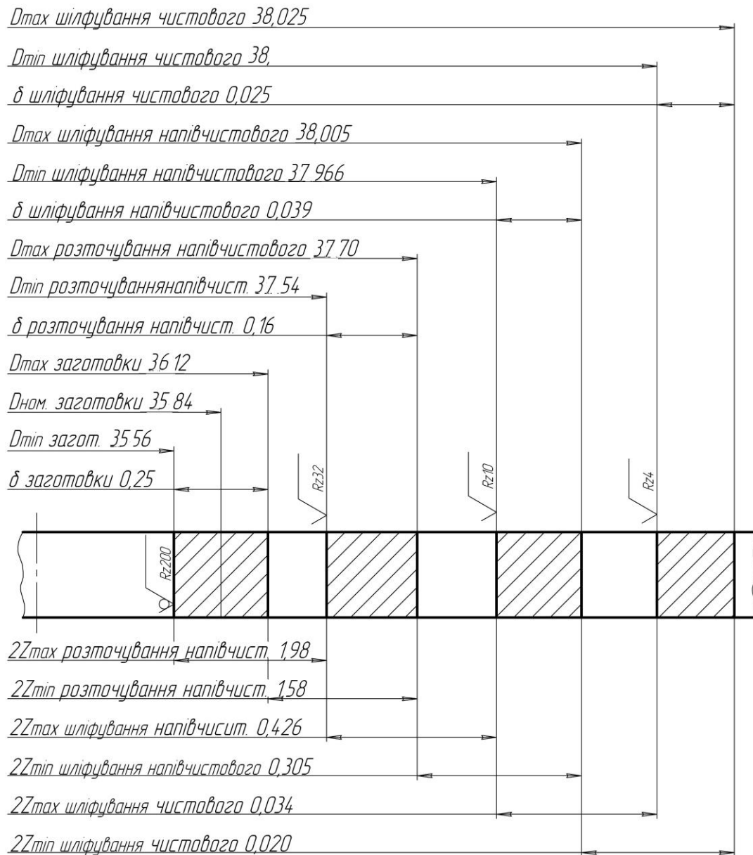
Рисунок 3.2 – Схема розміщення припусків, допусків і проміжних розмірів на обробку центрального отвору \varnothing 38H7^{(+0,025)} на операції 010 Автоматна токарна
