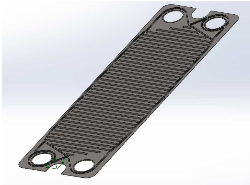
Рисунок 4.2.– 3d модель каналу руху продукту
