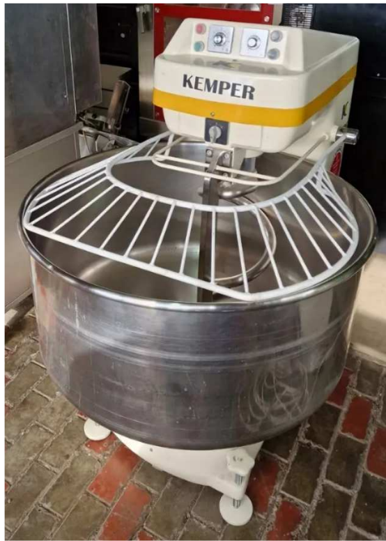
Рисунок 1.2. – Тістомісильна машина KEMPER SP 125 (125 л / 240 л).
