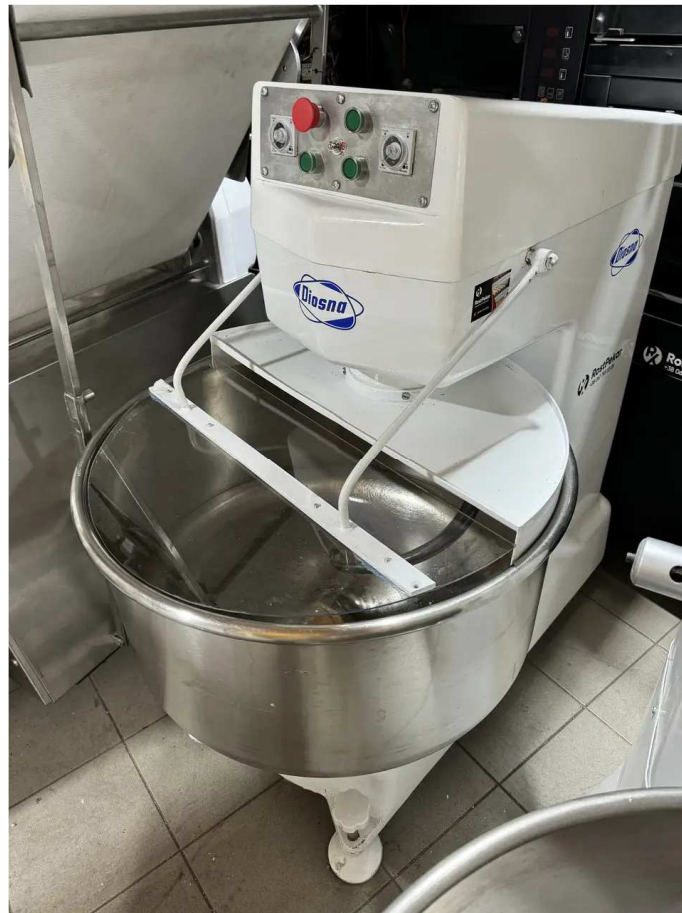
Рисунок 1.1. – Тістомісильна машина DIOSNA SP 120 (120 л / 180 л).
