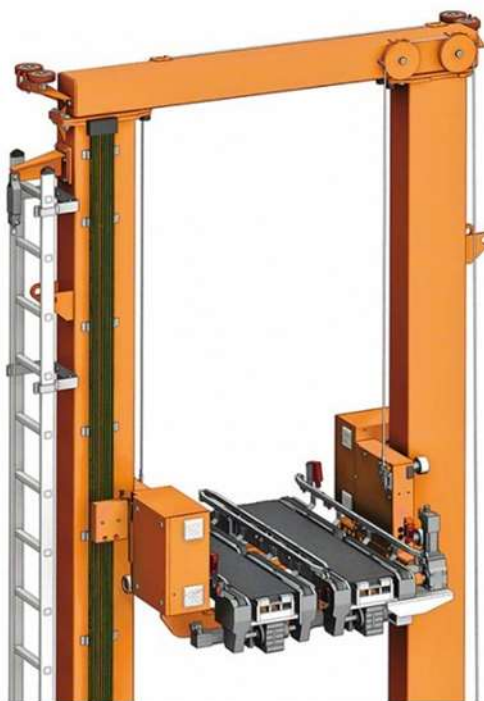
Рисунок 4.12 - Приклад структури осі Z
