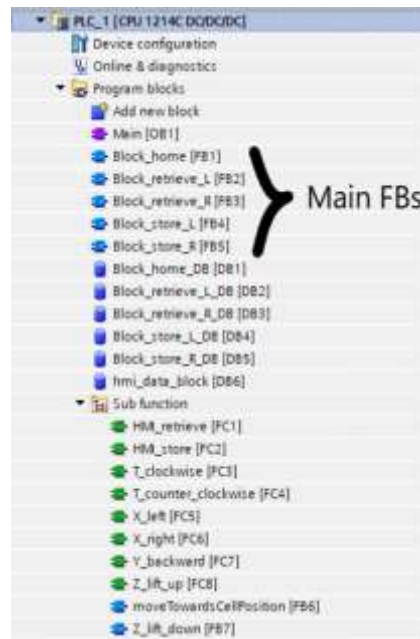
Рисунок 5.12 - Структура програмних блоків
