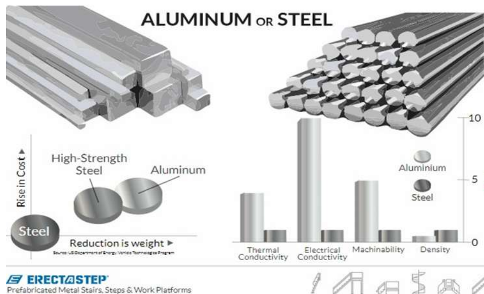
Рисунок 2.3 - Порівняння алюмінію та вуглецевої сталі
