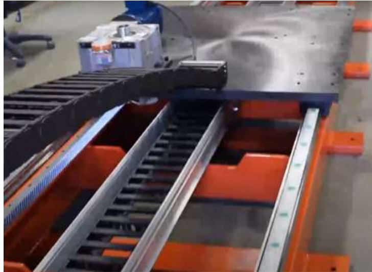
Рисунок 4.11 - Рейкова система для осі Y
