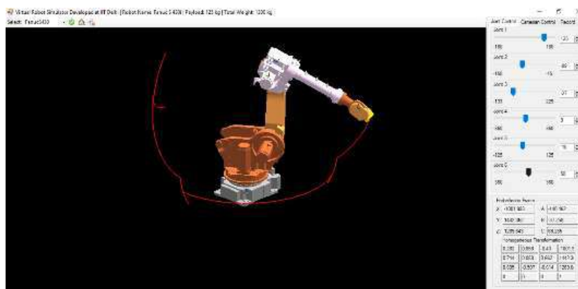
Рисунок 1.2 – Імпортована CAD модель FANUC S430i у VRS Robo-Analyzer
