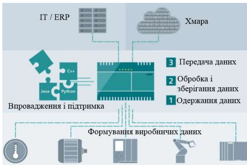
Рис. 1.15. Схема одержання, зберігання та накопичення даних про стан технологічного обладнання (Siemens).
