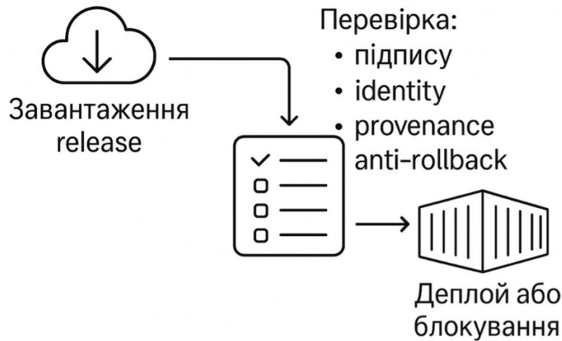
Рисунок 2.5 – Схема безпечного оновлення контейнерів із перевіркою підпису
