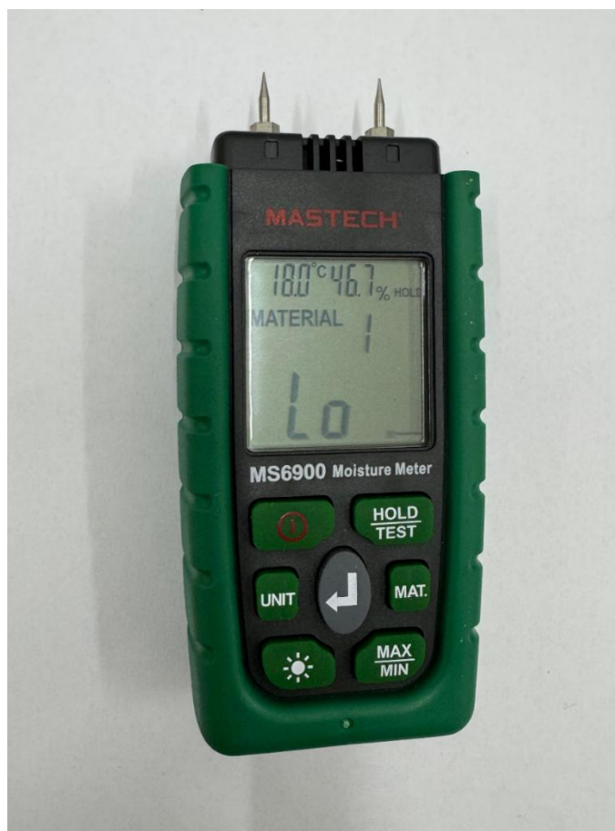
Рисунок 3.1 – Фото вологоміра Mastech MS6900 в лабораторії
