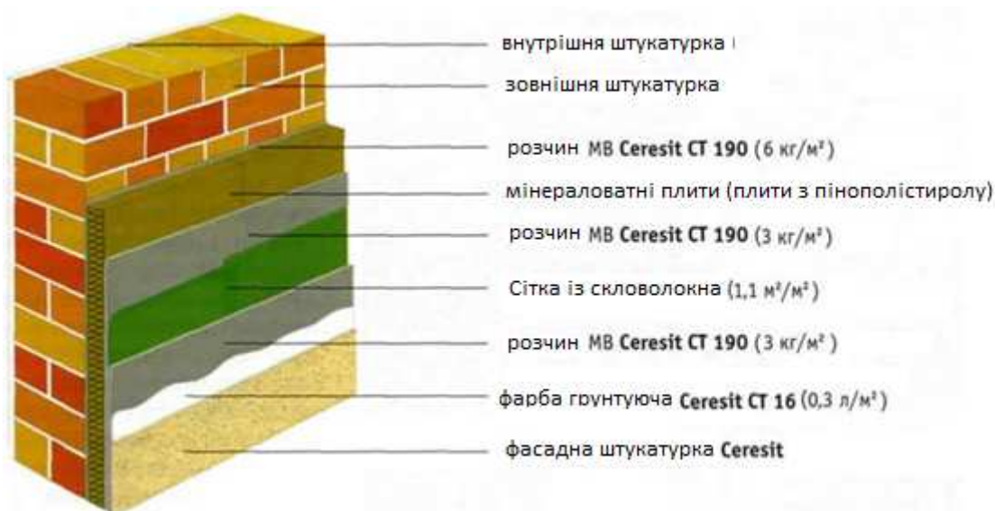
Рисунок 3.8 – Система утеплення Ceresit
