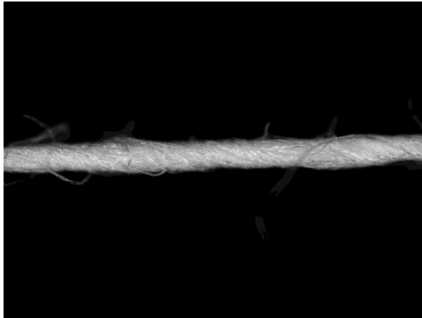
Рисунок 1.8. Спіральне намотування паралельного волокнистого сердечника
