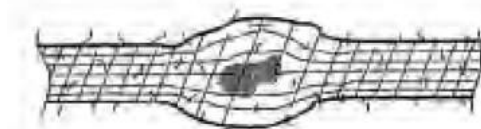
Рисунок 1.10 Товсте місце, спричинене забрудненням
